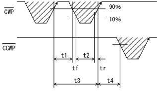
$t1 \ge 0.78 \,\mu$ s,  $t2 \ge 0.78 \,\mu$ s,  $tf, tr \le 1 \,\mu$ s  $t3>1.56 \mu s$ ,  $t4>1.56 \mu s$
