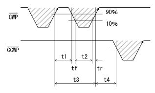
$t1 \ge 0.5 \mu s$ ,  $t2 \ge 0.5 \mu s$ ,  $tf, tr \le 1 \mu s$  $t3 \ge 1 \mu s$ ,  $t4 > 1 \mu s$
