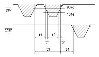
$t1 \ge 0.5 \mu s$ ,  $t2 \ge 0.5 \mu s$ , tf,  $tr \le 1 \mu s$  $t3 \ge 1 \mu s$ ,  $t4 > 1 \mu s$
