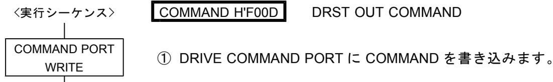
コマンドの実行で、DRST 信号を 10 ms 間 ON 出力します。
