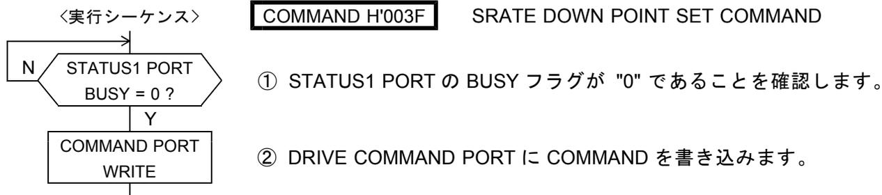
SRATE DOWN POINT SET コマンドは、すべてのパラメータを設定した後に一度だけ実行します。
