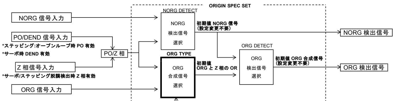
ステッピングモータドライバの PO 信号を検出する時
