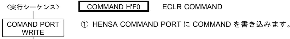
コマンドの実行で、脱調検出による MCC06 STATUS2 内の DALM 状態をクリアします。
