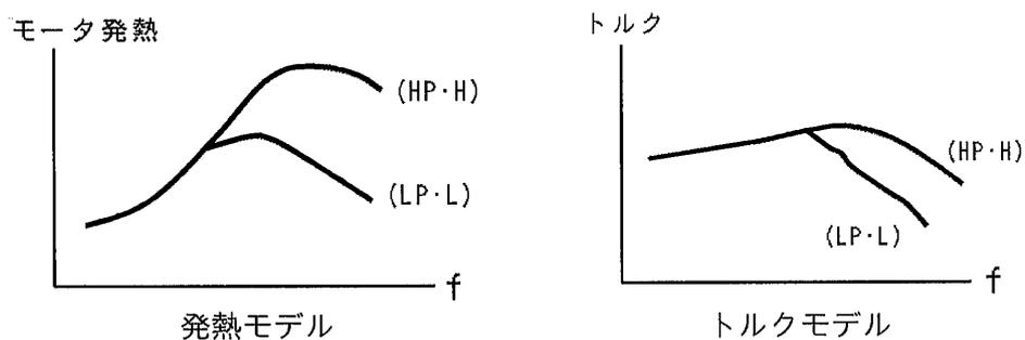
●高速トルクを必要とする場合はスイッチ (HP・H) を選択し、高速トルクが不要な場合はモータ発熱を抑えるために、スイッチ (HP・L) ~ (LP・L) を選択します。
