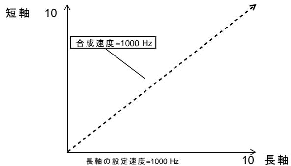
コマンド実行軸の速度を一定速の1000Hzとして
