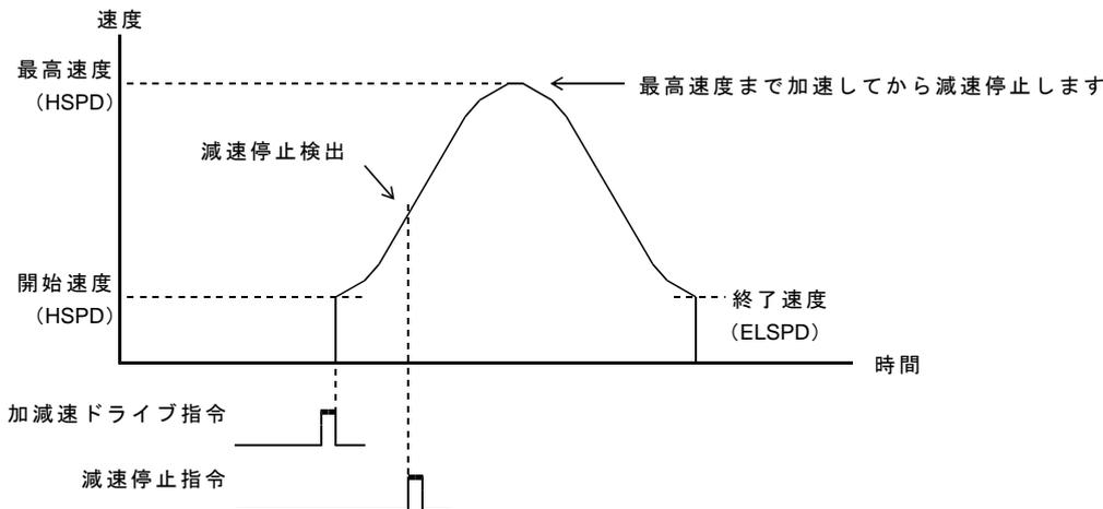
減速停止指令検出後の加速動作中に、INDEXドライブのマニュアル設定した減速パルス数で減速を開始した場合は、加速途中から補正しない減速カーブで減速を開始し、終了速度または指定位置で INDEXドライブを停止します。
