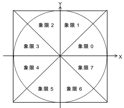
目的地が円周上に存在しない場合は、目的地と同じ象限内の短軸が一致した位置でドライブが終了しますが、目的地を下図の斜線部分に指定した場合は、各斜線部分と円周が接した点(下図の矢印)でドライブが終了します。
