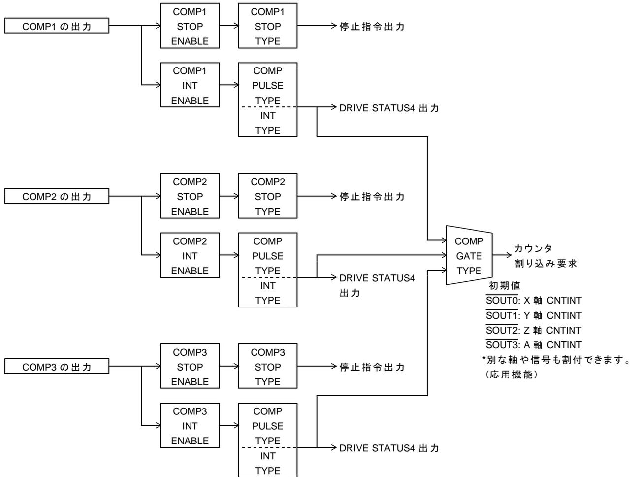
・コンパレータ出力機能は各カウンタ COUNTER INITIALIZE1, 2 コマンドで設定します。
