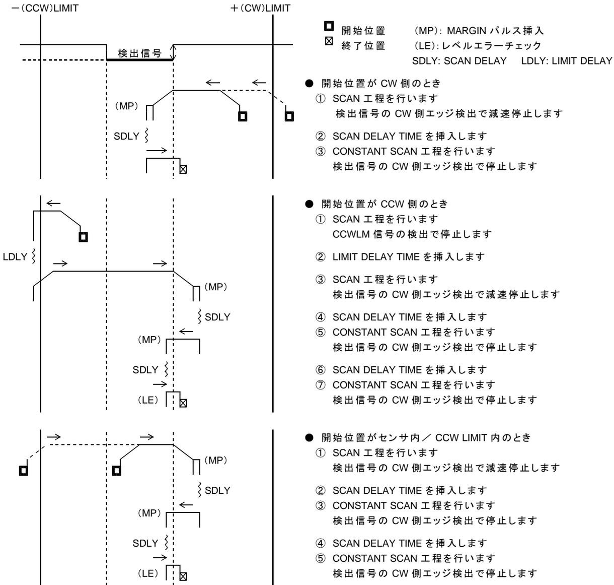
■ ORIGINドライブの起動方向が+(CW)方向の場合
