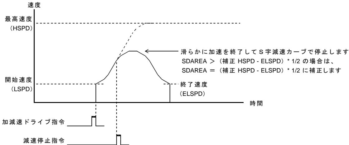
S字加減速の INDEXドライブでは、減速停止指令を検出すると、自動減速機能をマスクして、S字減速カーブ(または補正したS字減速カーブ)で減速停止します。減速中に INDEXドライブの指定位置を検出した場合は、指定位置で即時停止します。
