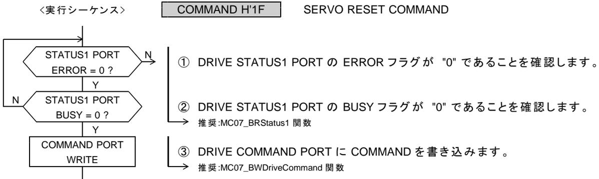
コマンドの実行で、DRST 信号出力に 10 ms 間アクティブレベルを出力します。
