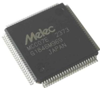
ステッピング & サーボモータチップコントローラ
