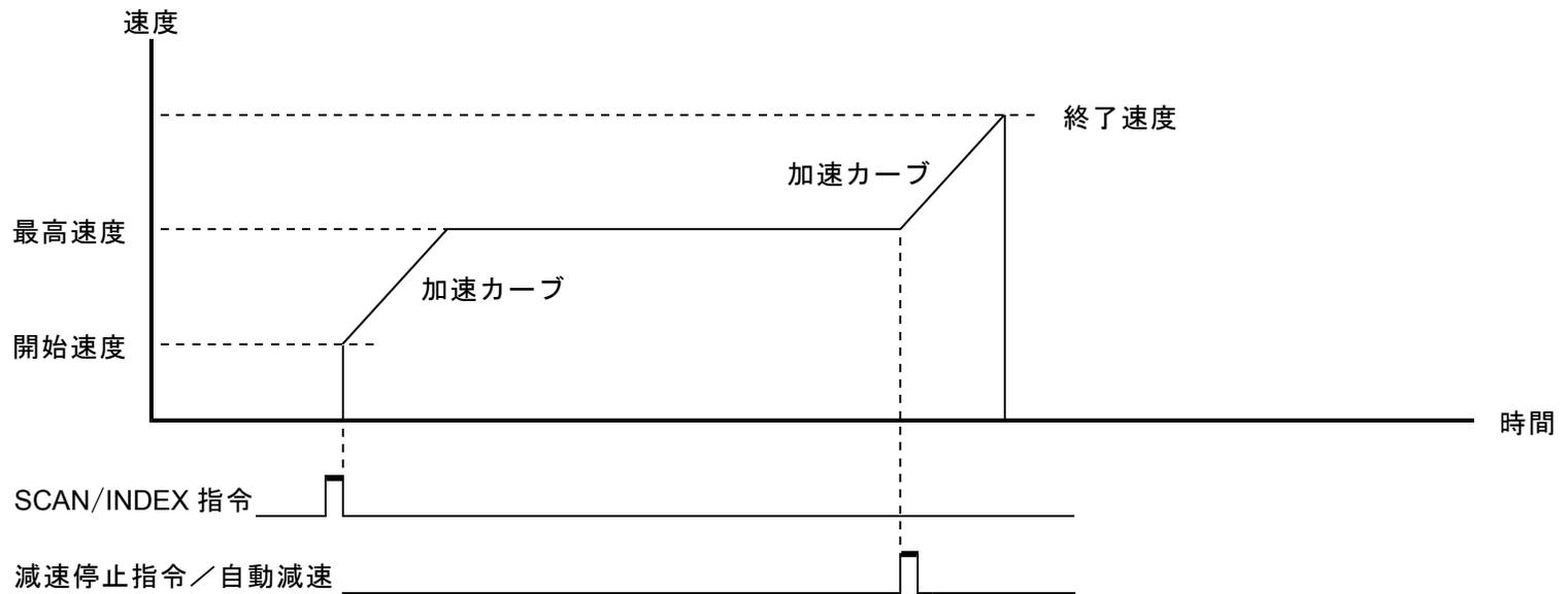
「開始速度>最高速度>終了速度」に設定すると、以下の減速ドライブを行います。
