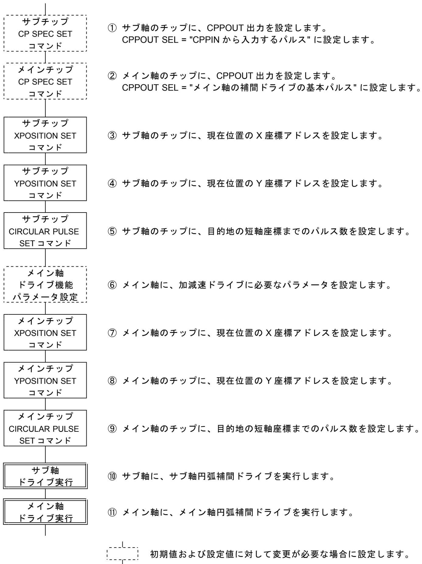
サブ軸円弧補間ドライブを実行すると、ドライブがスタンバイ状態になります。
