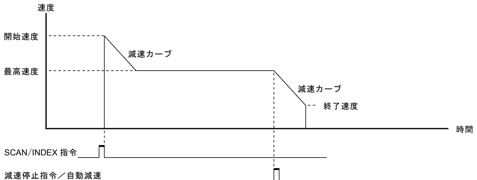
「開始速度>最高速度」および「最高速度<終了速度」に設定すると、以下の加減速ドライブを行います。
