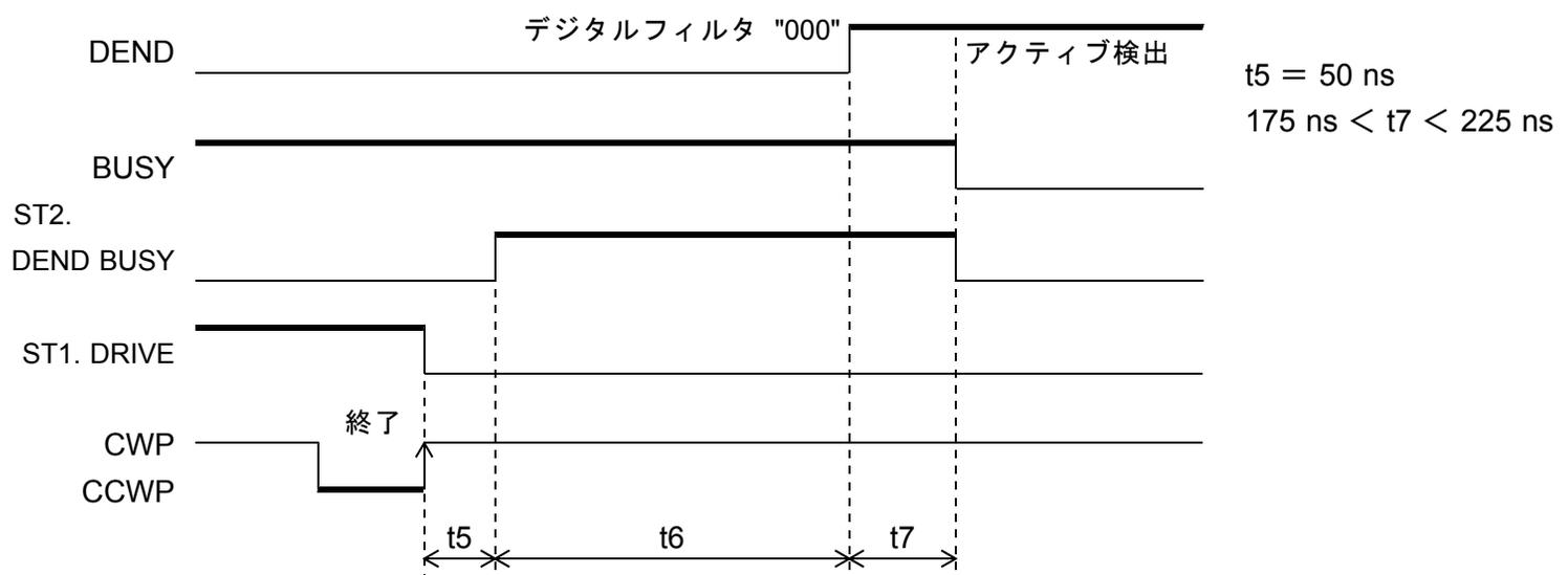
t6 は、サーボドライバの特性により変動します。
