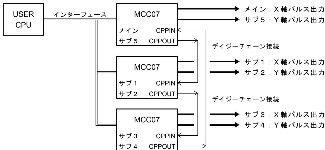
補間ドライブの基本となる加減速パルスは、メイン軸に設定した加減速パラメータで発生します。
