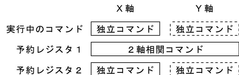
以下の 2 軸関連コマンド実行中は、X, Y 軸のどちらの軸で停止指令が発生しても有効になります。
