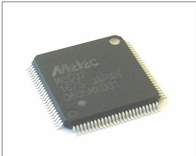
ステッピング & サーボモータチップコントローラ
