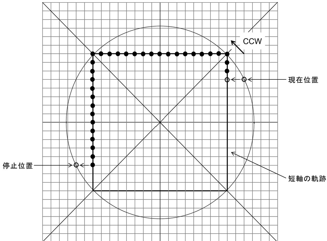
円弧補間ドライブは、円弧の中心座標からみた短軸側が補間ドライブの基本パルス（短軸パルス）を常に出力し、長軸側は基本パルス（短軸パルス）を補間演算して補間パルスを出力します。
