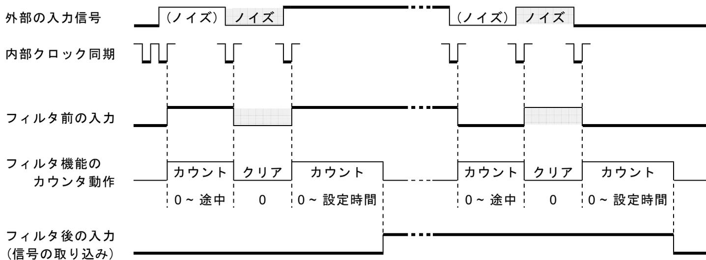
入力信号が L→H、または H→L に変化すると、フィルタ機能のカウントを開始して入力信号のレベルを計測します。フィルタ機能の設定時間分のカウントが終了すると、入力信号のレベルを取り込みます。
