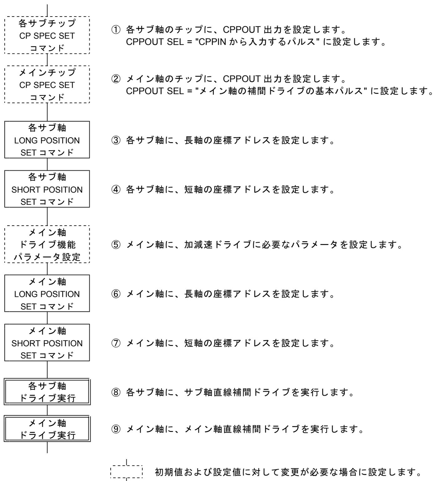
サブ軸直線補間ドライブを実行すると、ドライブがスタンバイ状態になります。
